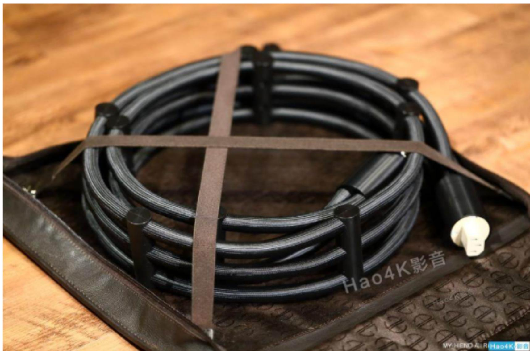
本次我們試聽的是首度引進臺灣的FRM EE旗艦系列中的電源線，從外觀上一個最明顯的區別就是FRM EE是Argento Audio所有產品中唯一採用黑色的產品，FRM EE從字面上就不難理解，是Argento在原本頂級的FRM系列下，全面提升的極致版本（Extreme Edition），光這條2M長的FRM EE電源線，就使用將近1Kg的6N純銀導體，水火地線均為獨立分離，電源公母頭也是Argento Audio專為FRM EE所量身打造，委由丹麥專業的工廠生產，電源公母頭內的導體均為6N純銀，Argento使用自家獨特的壓接方式以接合導體與介面，避免焊接造成的音質劣化。電源線中的地線設有遮罩，但火線與水線沒有，以避免增加傳導時的容抗。為了避免有刺耳單薄的聲音特性產生，Argento不使用任何跟塑膠有關的絕緣材料。為了提升線材的表現，所有元件都經過漸進控制的深冷處理。
